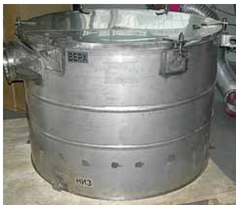
Фильтр-адсорбер АУИ со сменным сорбирующим картриджем
