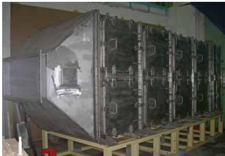
Установки фильтровальные комбинированные аэрозольной и йодной очистки для систем очистки технологических выбросов АЭС
